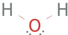
Gambar 2.4: Struktur Lewis untuk molekul \text{H}_2\text{O} , menunjukkan pasangan elektron bebas di sekitar oksigen.
