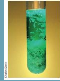
Gambar 50. Reaksi Pembentukan Padatan \text{Ni(OH)}_2
