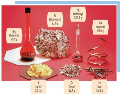
Gambar 30. Satu mol Hg, Cu, Fe, Zn, S, dan Br 2 Sumber: Whitten et al. , 2014
