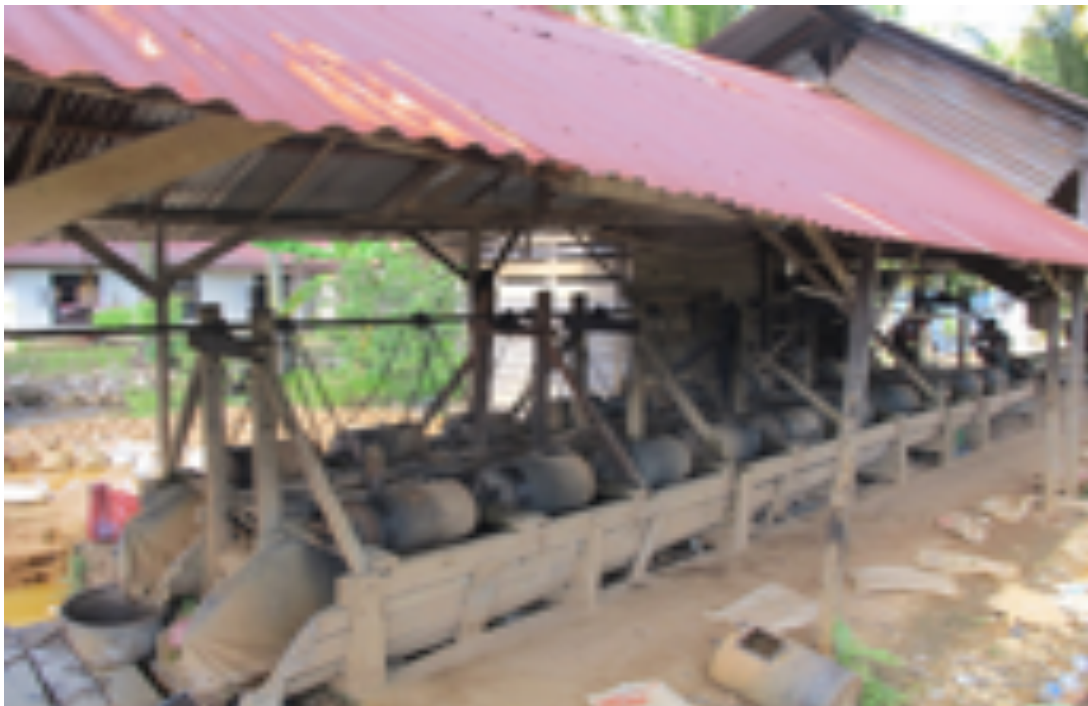
Gambar 1. Mesin penggilingan bijih emas dengan penggunaan merkuri dalam prosesnya
