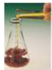
Gambar 1. Sodium kromat ditambahkan ke dalam larutan perak nitrat menghasilkan endapan \text{Ag}_2\text{CrO}_4 (Jespersen, 2011).
