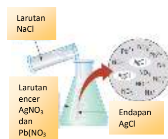
Gambar 2. Larutan NaCl dimasukkan ke dalam larutan \text{AgNO}_3 dan \text{Pb}(\text{NO}_3)_2 encer menghasilkan Endapan \text{AgCl} (Jespersen, 2011).
